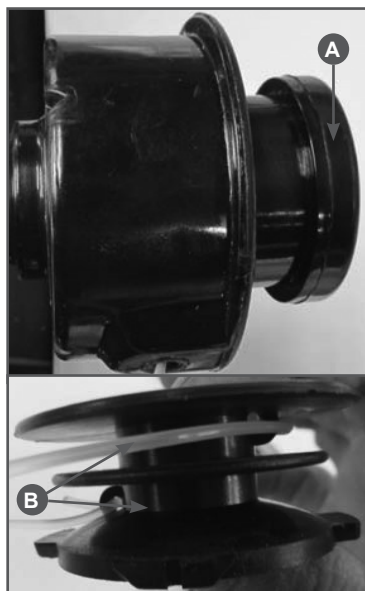
Рис. 10 Снятие крышки триммерной головки
